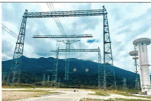
Foto 2: Arranjo de linha de transmissão de \pm 800 kV em corrente contínua montado na área de ensaios do Laboratório de Ultra-Alta Tensão Externo do CEPEL.
