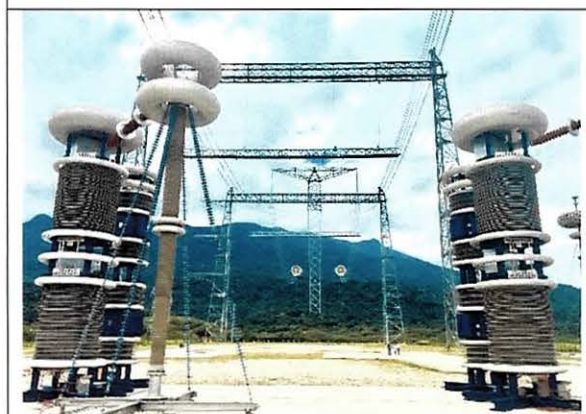
Foto 3: Fontes de tensão de corrente alternada e capacitor de acoplamento do Laboratório de Ultra-Alta Tensão Externo do CEPEL.
