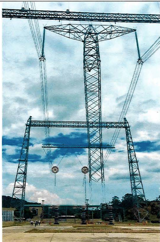
Foto 5: Detalhe do mockup da torre da linha de transmissão de \pm 800 kVcc, montada no Laboratório de Ultra-Alta Tensão Externo do CEPEL.
